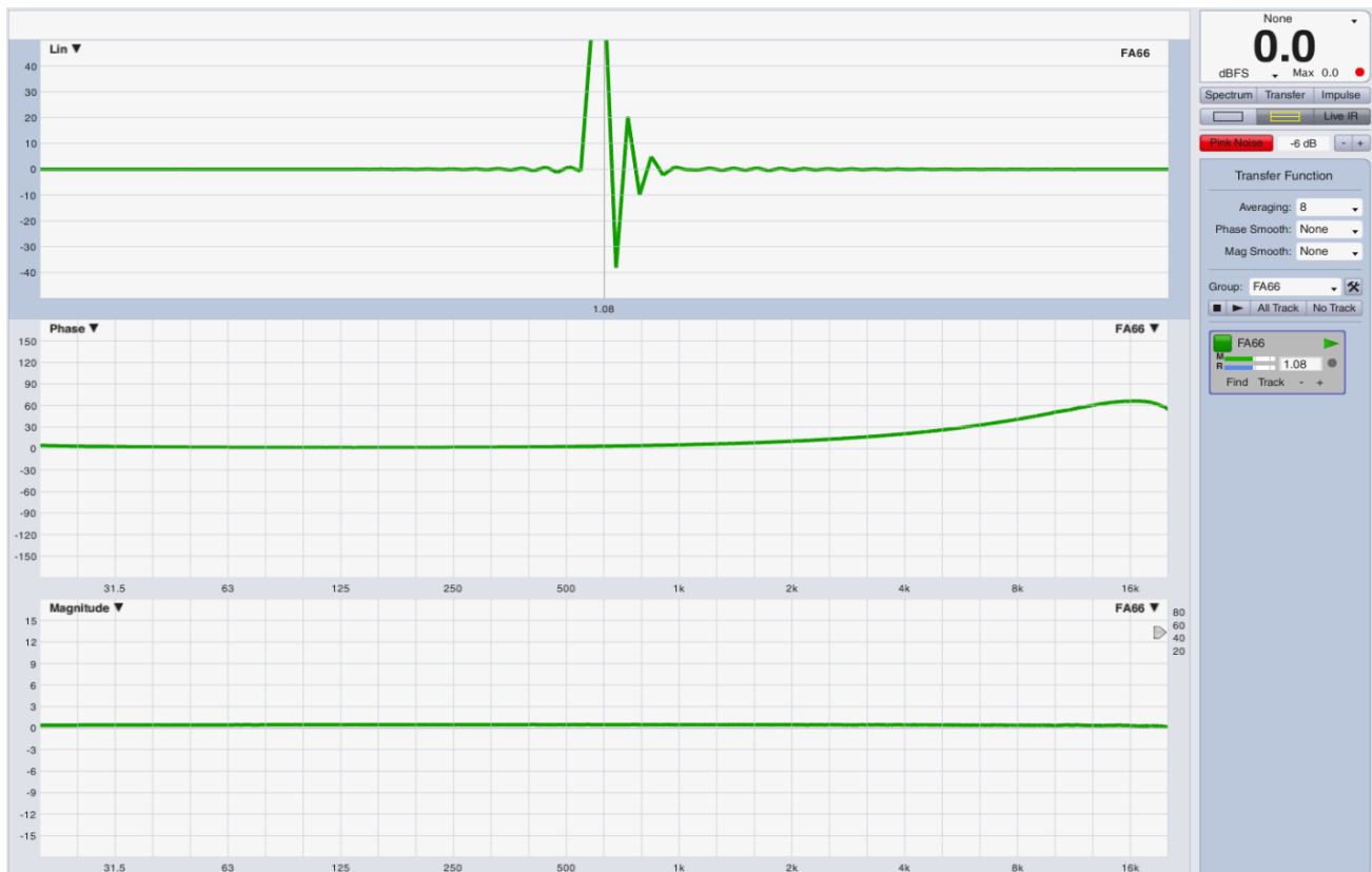
LM44@96kHz mit 48dB/LP bei 24kHz um einen Anti Aliasingfilter eines 48kHz Wandlers zu simulieren
