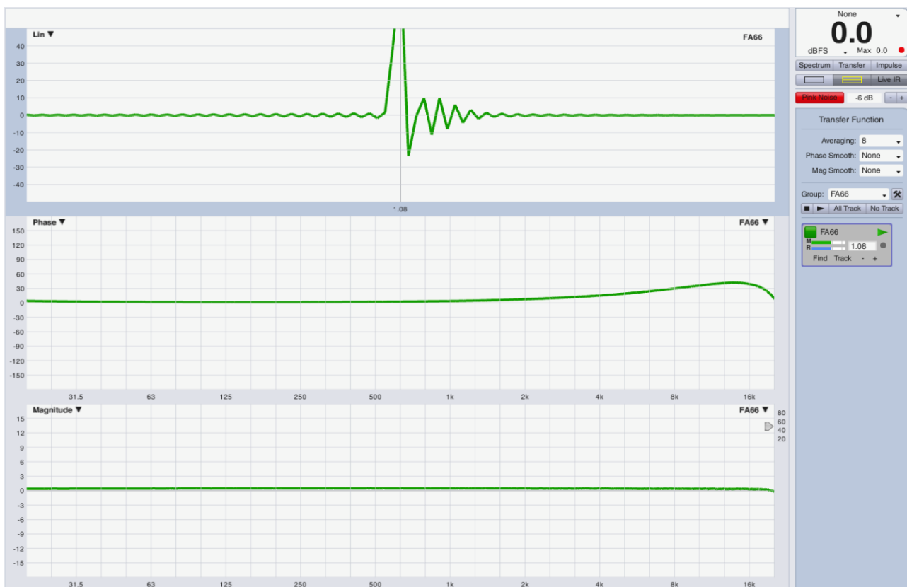
LM44 @ 96kHz mit 48dB LPF bei 22,05kHz um einen Anti Aliasingfilter eines 44,1kHz Wandlers zu simulieren
