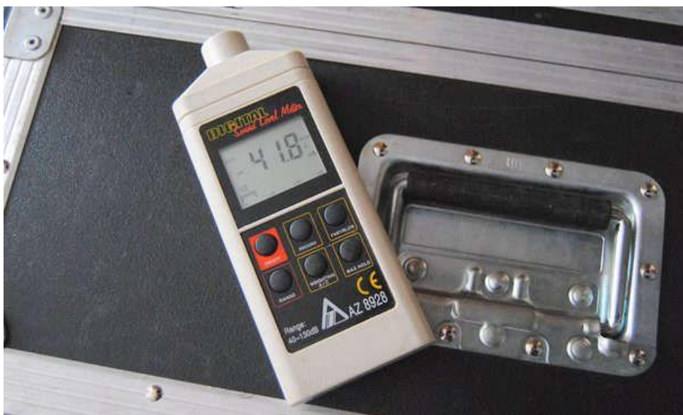
Ein einfaches SPL-Meter hilft beim Einstellen der Lautstärke einer Delay Line
