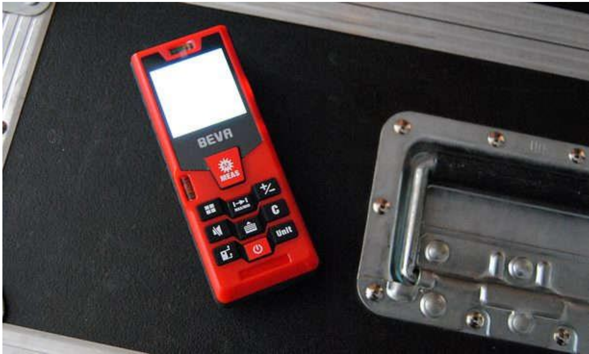
Ein Laser-Entfernungsmesser liefert rasch genaue Messwerte.
